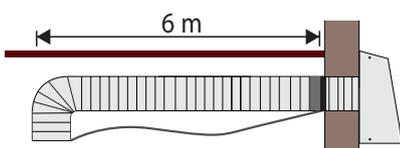
**Comprimento de até 6 metros** com cabo de energia do motor que acompanha a coifa.
