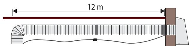
**Comprimento de até 12 metros** com extensão do cabo de energia do motor (venda via Rede de Serviço Autorizado).
