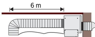
Comprimento de até 6 metros com cabo de energia do motor que acompanha a coifa.
