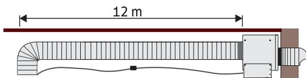
Comprimento de até 12 metros com extensão do cabo de energia do motor (venda via Rede de Serviço Autorizado).
