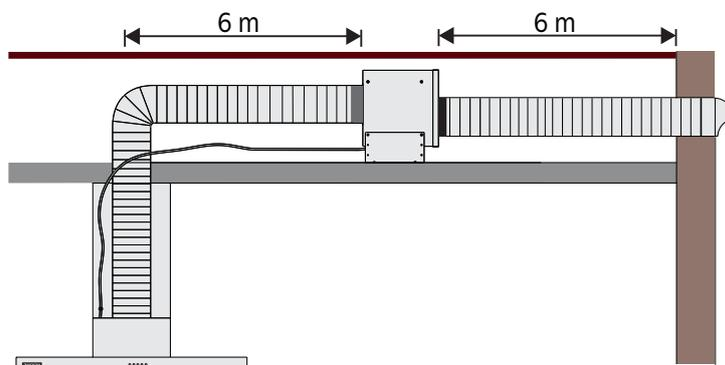
Comprimento de até 12 metros com cabo de energia do motor que acompanha a coifa.
