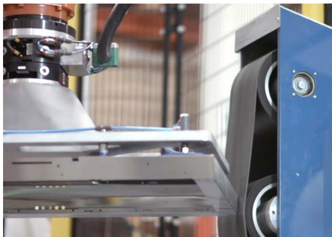
Linha automatizada de acabamento de coifas.
