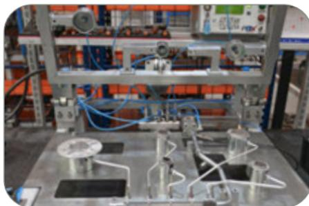
Equipamento para teste contra vazamentos.
