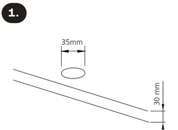
A dimensão do furo é de Ø 35 mm, e a espessura do tampo deverá ser de no máximo 30 mm.
