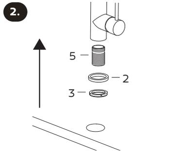
Coloque os componentes na mesma ordem da figura acima e, por fim, posicione no furo do tampo/pia.
