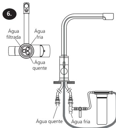
O misturador é compatível com todos os modelos de filtros com entrada de 1/2".
