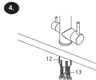
Conecte as mangueiras flexíveis (13) no misturador, apertando-as com as mãos. A mangueira flexível vermelha deve conectar-se na saída para água quente e a mangueira flexível azul deve ser conectada na água fria (conforme imagem no passo 6). Ao enroscar, tome cuidado para não torcê-las.
