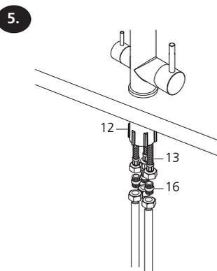
Conecte os flexíveis (13) ao abastecimento de água juntamente com os niples (16).
