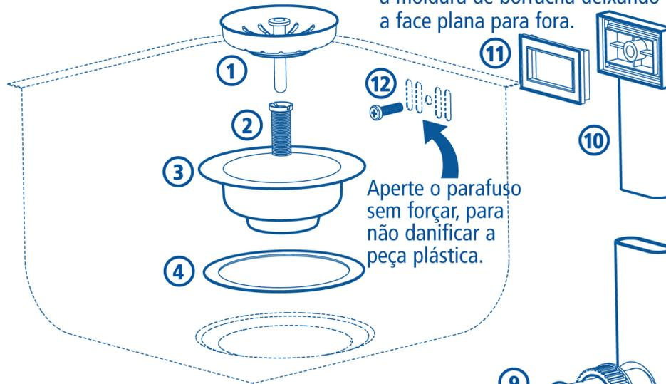
Aperte o parafuso sem forçar, para não danificar a peça plástica.
