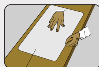
Furo Ø 10 mm para iniciar o corte com a serra tico tico Agujero de Ø 10 mm para comenzar el corte con la sierra caladora Hole Ø 3/8" for starting with jigsaw
