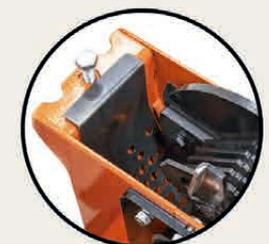
4 A peneira passa a ter uma dobra que facilita a retirada e colocação, além de melhorar a vedação e a passagem do material
