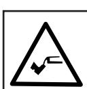
Manténgase alejado de la lámina del equipo mientras el motor esté prendido.
