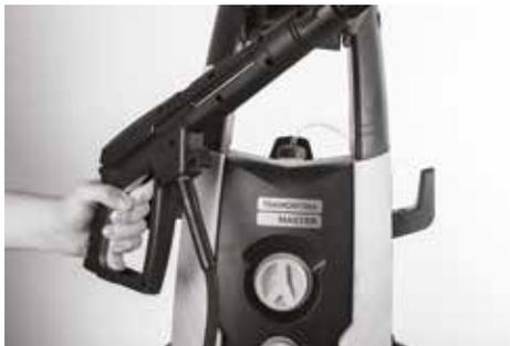
**NOTA:** nunca encender la hidrolavadora con aire en las mangueras, eso puede provocar que el motor se quemé.
