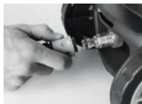
Fixação do engate rápido na lavadora
