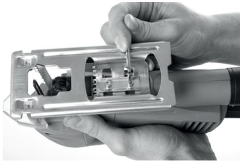
**\*\*Nota:** La base tiene algunas ranuras que se deben encajaren los dientes de la estructura de la herramienta para garantizar la fijación.
