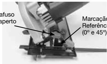
**NOTA: a regulagem do ângulo de trabalho permite cortes chanfrados na peça de trabalho. Observe sempre que a base guia deve ser apoiada firmemente contra o material para evitar vibrações ou quebra do disco.**
