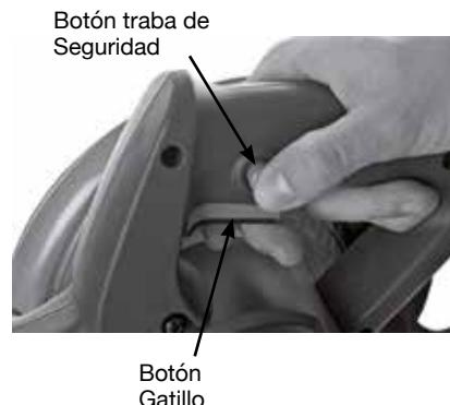
**NOTA:** siempre utilice ambas manos apoyadas en la empuñadura y en el apoyo de la herramienta durante el trabajo de corte.
