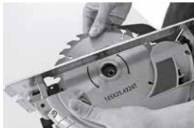
d) Observe sempre que o guarda de proteção cobre a lâmina antes de ser apoiada no chão ou mesa de trabalho. Uma lâmina de proteção pode causar a movimentação accidental da serra, cortando todo material ou objeto que estiver nas proximidades. Esteja consciente do tempo necessário para que a rotação da lâmina pare por completo após o gatilho ser liberado.
