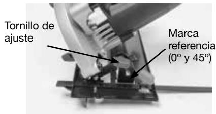
**NOTA:** el regulado del ángulo de trabajo permite cortes chanfeados en la pieza de trabajo. Observe siempre que la base guía debe apoyarse firmemente contra el material para evitar vibraciones o quiebra del disco.
