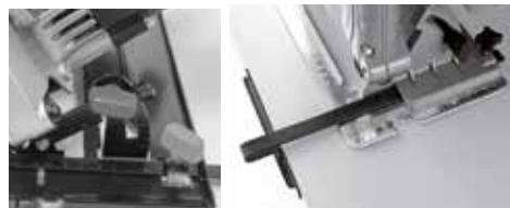
**NOTA:** antes de hacer el corte en la pieza de trabajo, haga un corte de ensayo para verificar si los ajustes de ángulo, ancho y/o profundidad están correctos.
