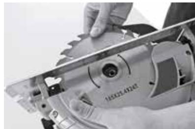
d) Observe siempre que el protector cubre la lámina antes de apoyarse en el piso o en la mesa de trabajo. Una lámina de protección puede causar movimientos accidentales de la sierra, cortando todo el material u objeto que esté en sus proximidades. Tenga conciencia del tiempo necesario para que la rotación de la lámina pare completamente después de soltar el gatillo.
