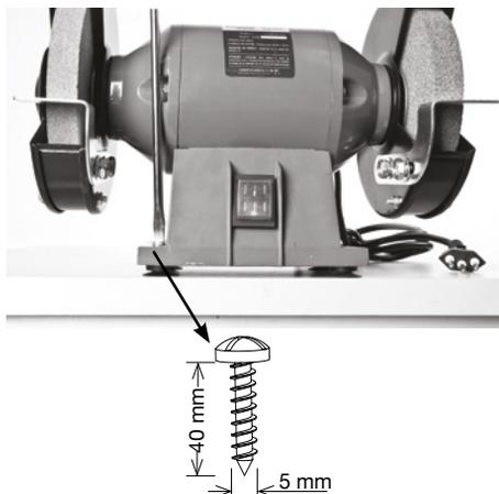
**Nota:** Es posible utilizar un conjunto ‘tornillo-tuerca’ para fijar el equipamiento. En este caso, el diámetro del tornillo debe ser de 5 mm y el largo debe ser mayor a 25 mm.
