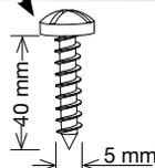
**Nota:** pode-se também utilizar um conjunto “parafuso-porca” para fixar o equipamento. Neste caso, o diâmetro do parafuso deve ser de 5 mm, e o comprimento deve ser maior que 25 mm.
