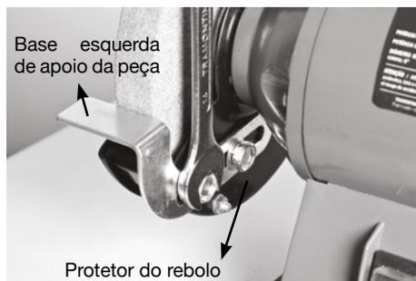
**Nota:** a distância entre a base de apoio da peça e o rebolo deve ser de 2 a 4 mm. Sempre que o rebolo diminuir o seu diâmetro em função do desgaste provocado pelo uso, deve-se afrouxar os 2 parafusos e ajustar o conjunto novamente, a fim de que a distância de 2 a 4 mm seja sempre respeitada.
