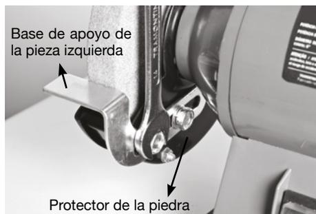
**Nota:** La distancia entre la base de apoyo de la pieza y la piedra debe ser de 2 a 4 mm. Siempre que la piedra disminuya su tamaño debido al desgaste proveniente del uso, se debe aflojar los dos tornillos y ajustar el conjunto nuevamente, a fin de que la distancia de 2 a 4 mm sea siempre respetada.
