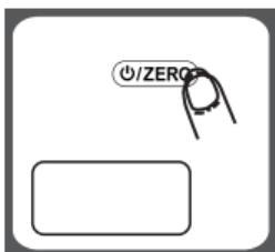
Para maximizar a vida útil da bateria, pressione **(O/ZERO)** para desligar a balança após o uso.
