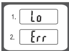
1. Bateria fraca - Substitua por uma nova bateria.
