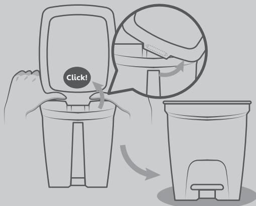
**Deslize a tampa para que o outro pino encaixe. Por fim, retorne a lixeira para sua posição normal. Atente ao funcionamento adequado do produto!**
