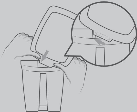
**Forre a superfície de montagem e posicione a lixeira de face para baixo. Depois, encaixe um dos pinos da tampa em um dos furos do rebaixo indicado na figura.**
